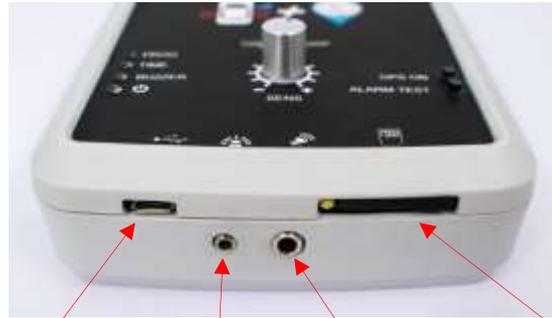
USB-Socket      LED Socket      Siren Socket      SIM-Slot
