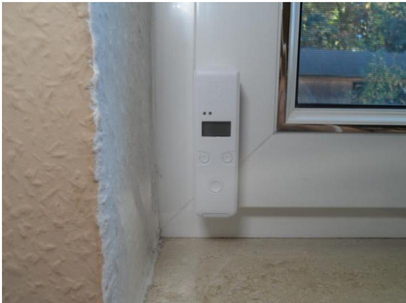
Achten Sie beim Kleben darauf, dass der Sensor bündig am Rand des Fensterflügels oder der Türe befestigt wird. Achtung: das Klebepad klebt sehr stark. Ein einmal befestigter Sensor kann nicht wieder abgelöst werden. Wenn sich der Sensor an der richtigen Position befindet, drücken Sie den Sensor fest an, die Klebeverbindung erreicht nach ca. 1 Stunde seine endgültige Festigkeit.
