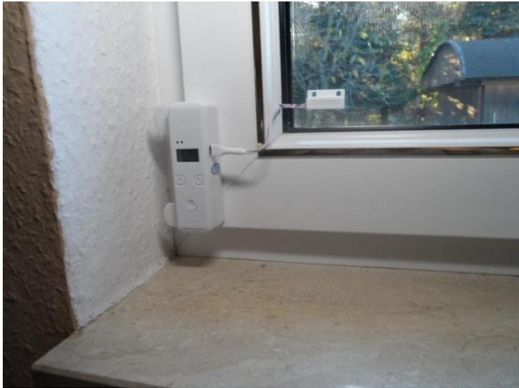
Reinigen Sie die Fensterscheibe gründlich bevor Sie den Glasbruchmelder mit dem Klebepad auf die Scheibe montieren. Verbinden Sie das Kabel des Glasbruchmelders am Micro USB-Anschluss des Fenster-/Kombimelders. Die USB Buchsen auf der rechten und linken Seite haben eine identische Funktion und können frei gewählt werden, je nachdem ob der Sensor rechts oder links am Fenster montiert wurde.
