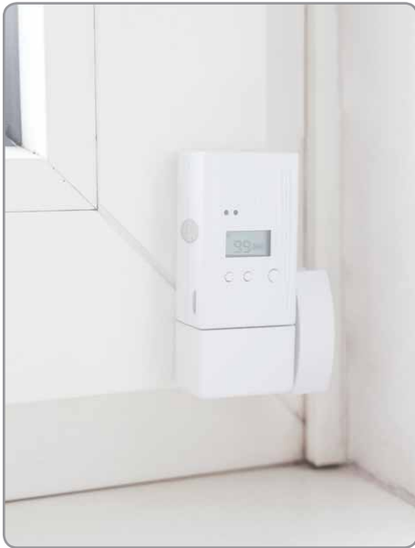
Fenstersensoren warnen, wenn ein Fenster oder eine Tür aufgebrochen wird
